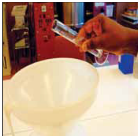
៣. Glycerol ត្រូវបានបន្ថែមប្រើស៊ីឡាំងរង្វាស់។ ដោយសារ Glycerol មានលក្ខណៈអន្តាយ និងស្អិតជាប់ជញ្ជាំងស៊ីឡាំងរង្វាស់ វាគួរត្រូវបានគេលាងសម្អាតជាមួយទឹកប៊ិតស្ទើរលម្អយចំនួន ឬជាមួយទឹកដាំពុះត្រជាក់ បន្ទាប់មកចាក់ចូលទៅក្នុងដប ឬពីដុងឱ្យអស់។
